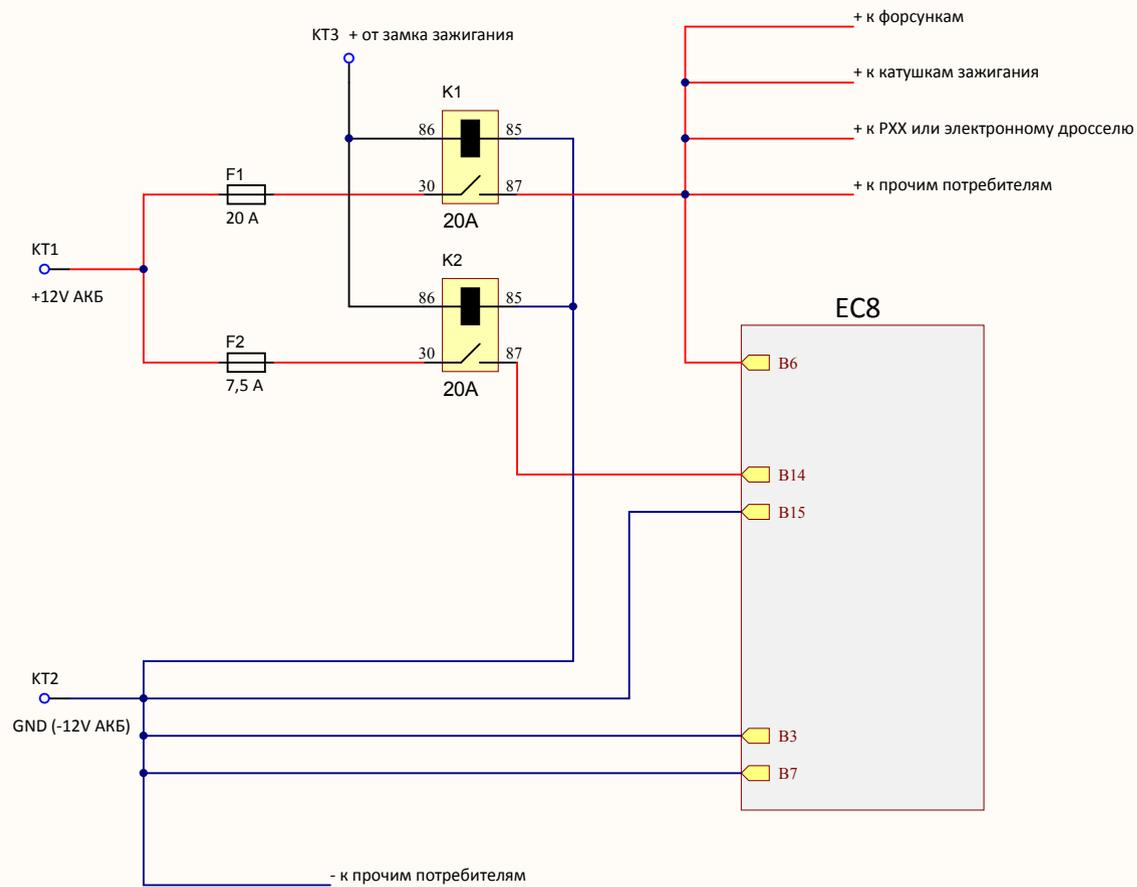
K1 - реле питания силовой части оборудования.
