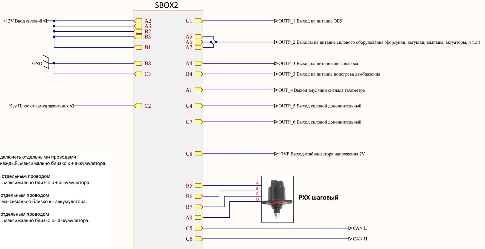
A2, A3, B2, B3 - подключать отдельными проводами не менее 1,5 кв. каждый, максимально близко к + аккумулятора.
